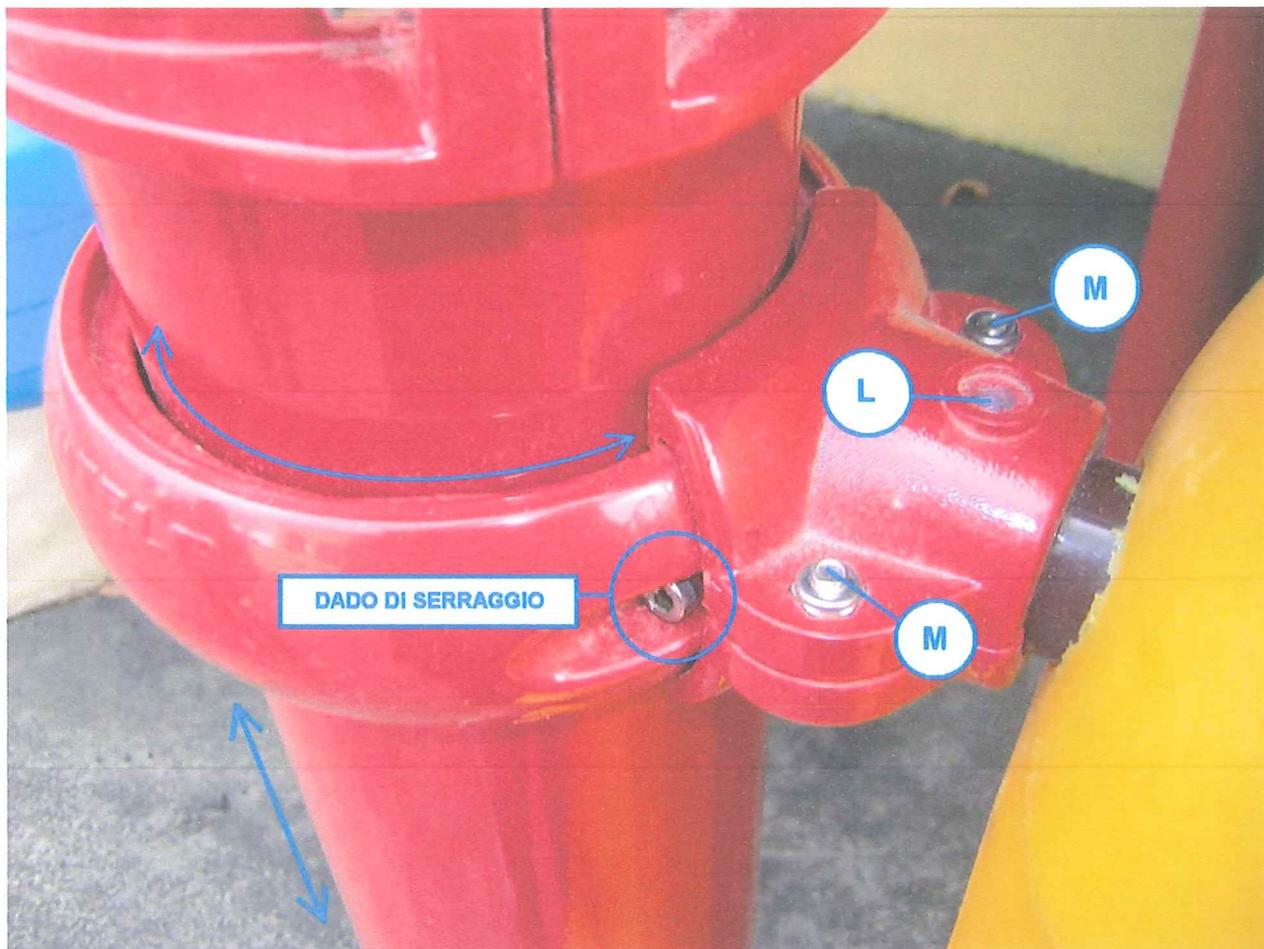
**NB:** Per poter muovere gli anelli è necessario allentare il relativo Dado di Serraggio (come da foto sopra). I morsetti vengono solitamente fissati con le due viti laterali "M", mentre la vite centrale "L" è del tutto opzionale e per poter servirsene è necessario forare il tubo del pannello con un trapano.
