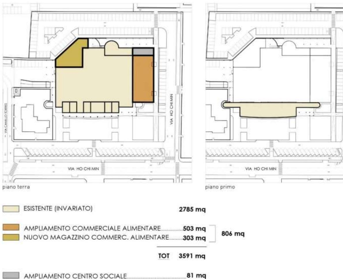
Fig. 1.1.a – indicazione delle aree oggetto di trasformazione per l'immobile di interesse piano terra (a sx) e piano primo (a dx)
